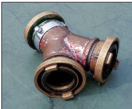
É um aparelho de metal que tem uma única saída e duas ou mais entradas para água, podendo coletá-la de fontes distintas. Possui ou não registro de paragem e providos de juntas de união, do tipo engate rápido (STORZ) nas admissões e expulsões. Alguns são providos internamente de válvula de retenção, para recalques a grandes alturas. O diâmetro de ambas as entradas, admissão e expulsão, será normalmente de 63mm.
