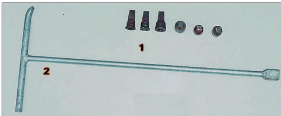
**Chave de registro de Hidrante tipo VOLANTE** – para abrir os registros de hidrante que possuem volante e os mesmos encontram-se além do alcance de um braço. O conector triplo da extremidade, chamado de “pé de galinha” é encaixado no volante da válvula e ao se girar a barra transversal, a torção é transmitida ao volante permitindo a operação da válvula.
