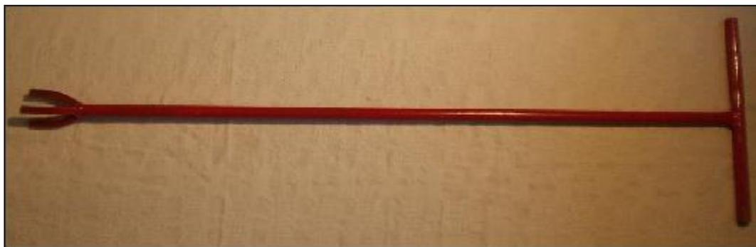
**Chaves de conexão** – são chaves que se destinam a facilitar as manobras de acoplamento e desacoplamento de juntas ou a abertura e fechamento de bocais.
